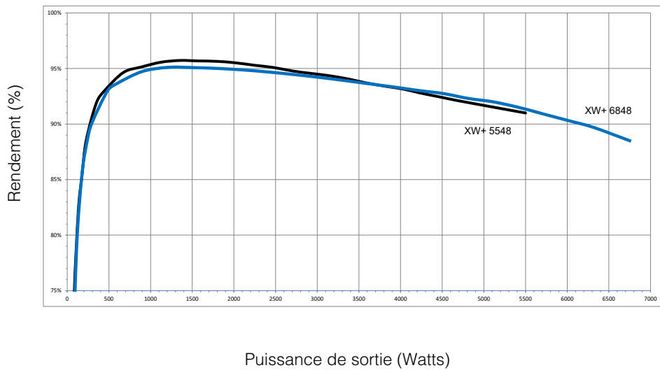
Figure A-3 Rendement en mode onduleur (normal)
