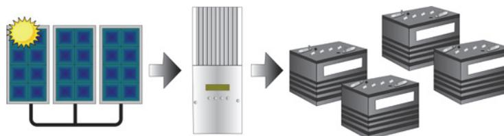
**Figura 1-2** Regolatore di carica solare
