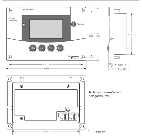
Figura A-1 Dimensões SCP
