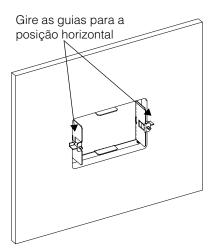
Figura 2-5 Prendendo a Placa de Montagem
