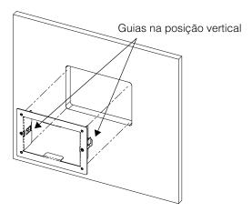
Figura 2-4 Instalação da Placa de Montagem
