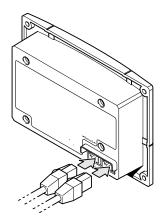
Figura 2-6 Conectando os Cabos de Rede
