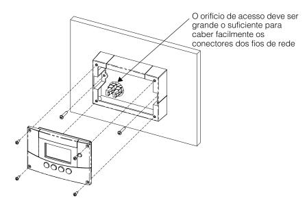
Figura 2-8 Montagem da Superfície do SCP
