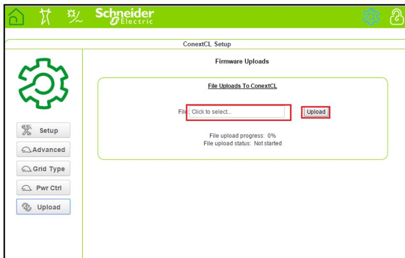
**Figura 5-14** Pantalla de actualización del firmware mediante páginas web
