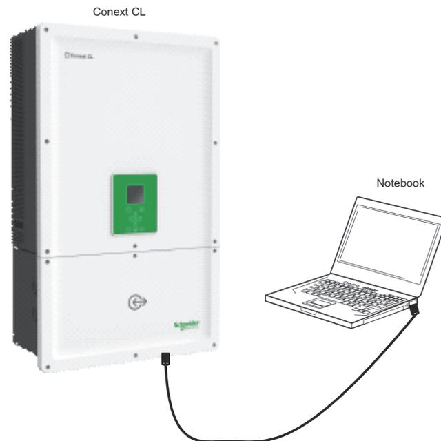
Abbildung 2-55 Anschlussdiagramm für die Webschnittstelle
