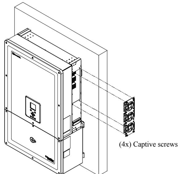
Figure 5-6 Removing the fan
