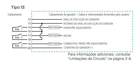
Figura 2-21 Diagrama de Conexão do Tipo 13
