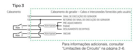
Figura 2-9 Diagrama de Conexão do Tipo 3
