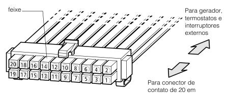
Figura 2-6 Conext AGS Cabeamento
