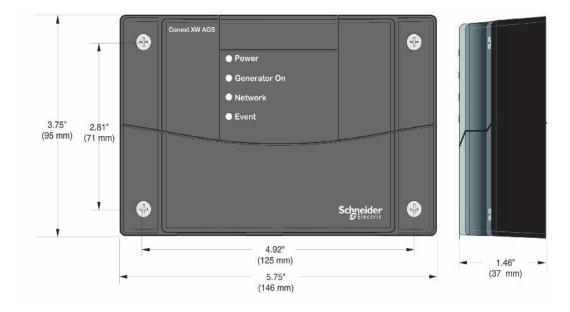
Figura A-6 Conext AGS Dimensões
