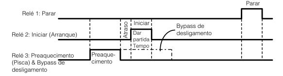
Figura C-11 Diagrama de Regulação do Tempo no Modo de PulseStop
