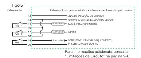
Figura 2-11 Diagrama de Conexão do Tipo 5
