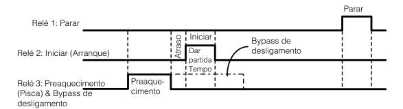
Figura C-10 Diagrama de Regulação do Tempo no Modo do StartStop
