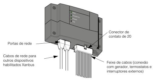
Figura 2-5 Conexões Externas do Conext AGS
