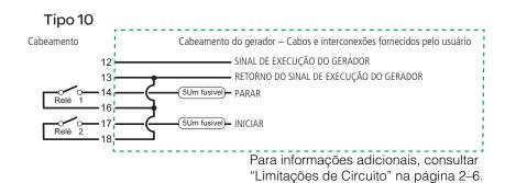
Figura 2-18 Diagrama de Conexão do Tipo 10
