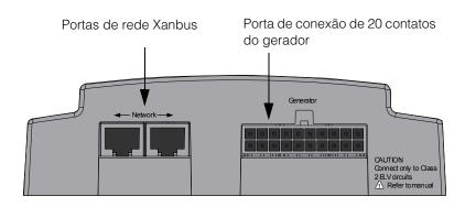
Figura 1-3 Conext AGS Painel Inferior
