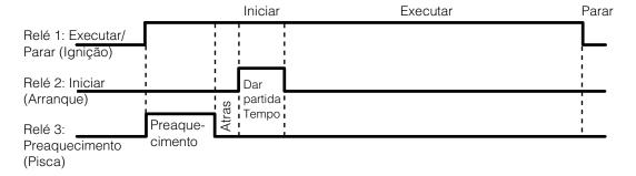
Figura C-7 Diagrama de Regulação de Tempo do RunMode
