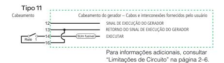
Figura 2-19 Diagrama de Conexão do Tipo 11
