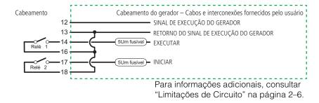
Figura 2-14 Diagrama de Conexão do Tipo 7 (três fios)
