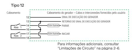
Figura 2-20 Diagrama de Conexão do Tipo 12
