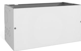
La caja de conductos es fácil de fijar a través de dos tornillos incluidos en la parte inferior del inversor. A continuación, la brida inferior de la caja de conductos puede fijarse (no se proporcionan tornillos) a la pared para completar la instalación. El panel frontal de la caja de conductos se desmonta retirando los dos tornillos de la parte delantera, lo que proporciona suficiente espacio para realizar todas las conexiones de cableado necesarias.
