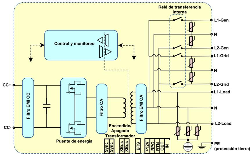
Figura A-6 Diagrama de bloques Conext XW+
