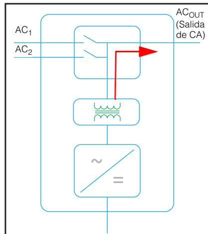
**Figura 1-2** Inversión de CC a CA conectado a AC Out (Salida de CA)
