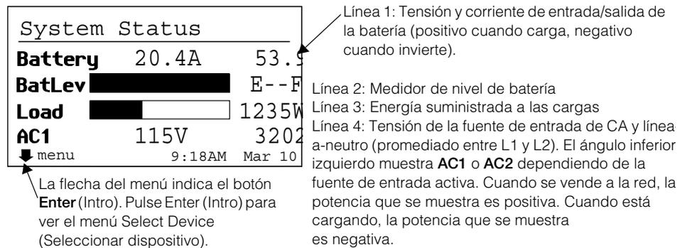
Figura 2-6 Pantalla System Status (Estado del sistema)
