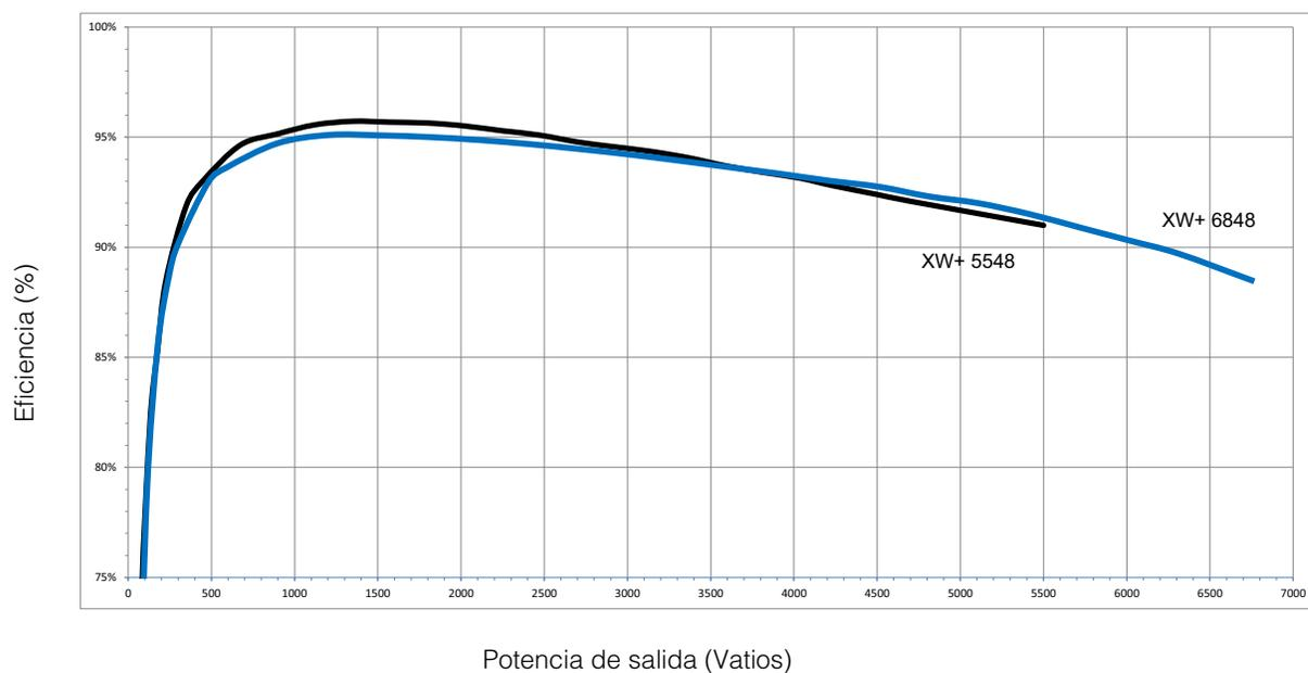
Figura A-3 Eficiencia de inversión (típica)
