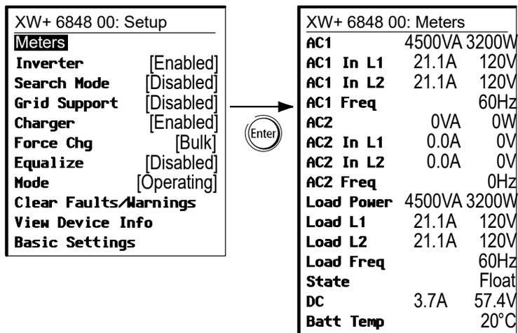
Figura 2-8 Vista de la pantalla **Meters** (Medidores)
