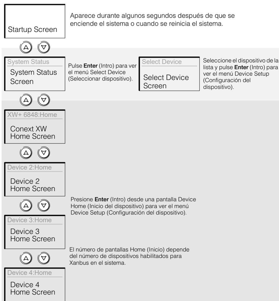
**Figura 2-4** Panel de Control del Sistema Conext Pantallas superiores
