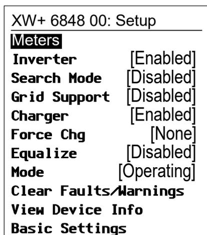
**Nota:** El SCP del Conext muestra solo cuatro líneas por vez del menú `Setup` (Configuración). Para ver parámetros adicionales, pulse el botón Flecha abajo.
