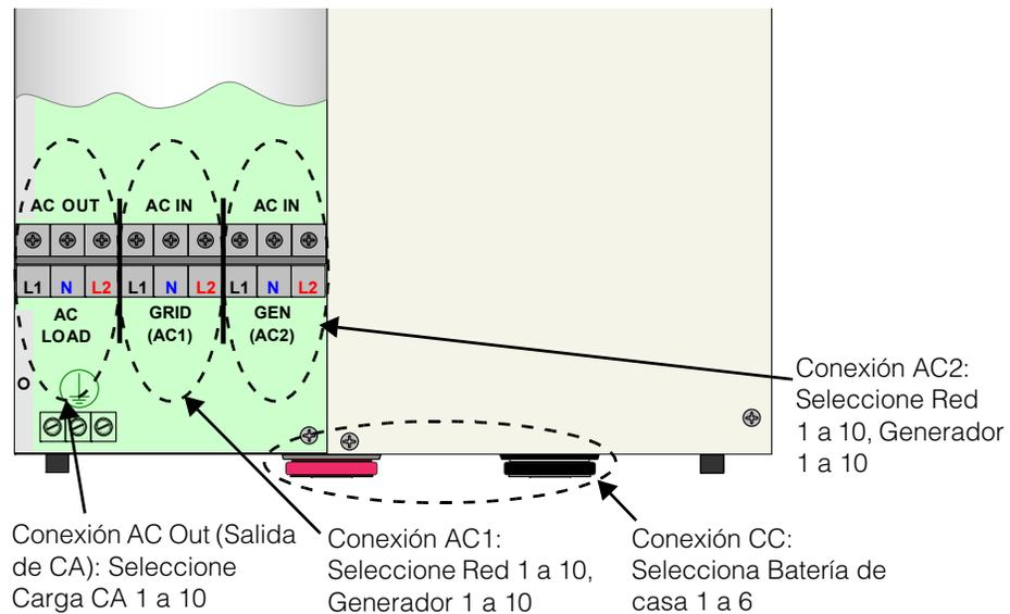
**Figura 3-11** Representación de las conexiones de Conext XW+
