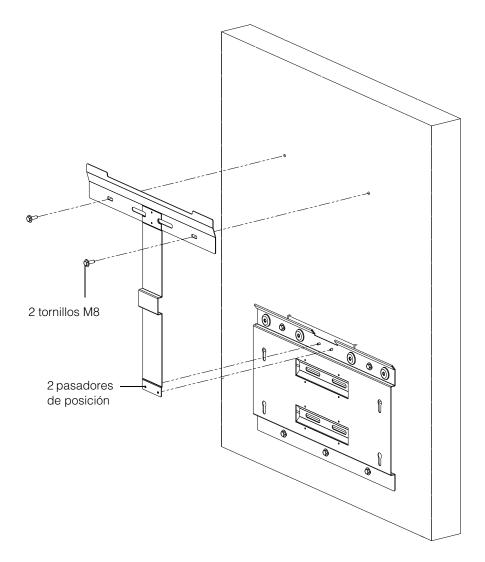
Figura 2-17 Fijación a la pared de la placa de montaje del inversor
