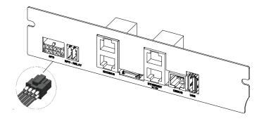
Figura 2-43 Conexión del cable de supervisión SPD
