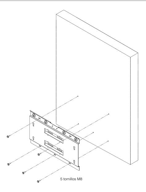
Figura 2-16 Fijación a la pared de la placa de montaje de la caja eléctrica
