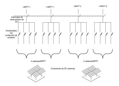
**Figura 2-33** Diagrama de cableado de energía fotovoltaica de los modelos Conext CL 20000E y 25000E
