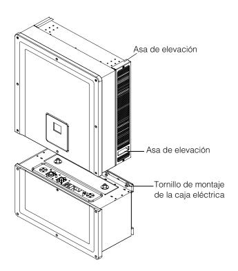
Figura 2-22 Inversor y caja eléctrica: plano de despiece
