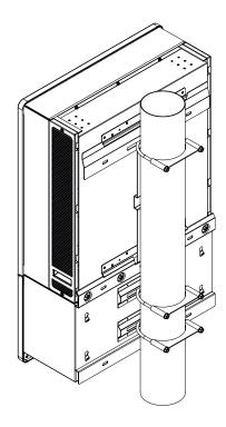
Figura 2-21 Montaje en postes: vista trasera con el inversor instalado
