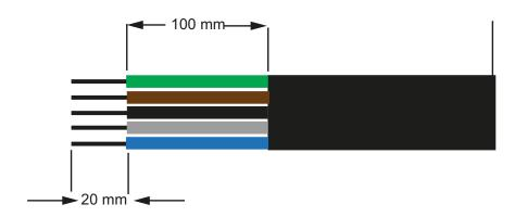
Figura 2-39 Cableado de AC
