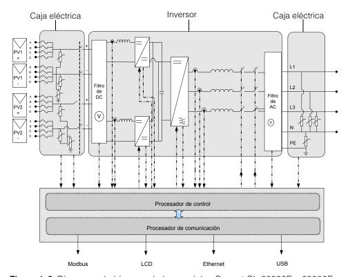
Figura 1-2 Diagrama de bloques de los modelos Conext CL 20000E y 25000E
