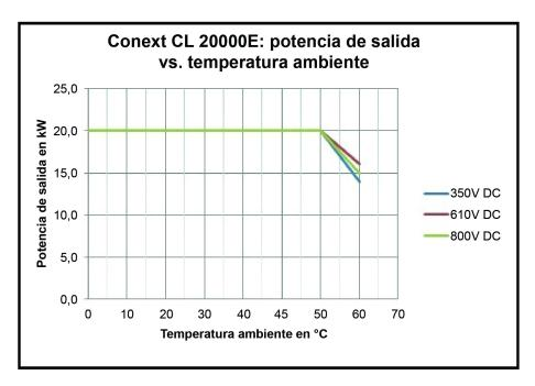
Figura A-3 Curva de reducción: 20 KW
