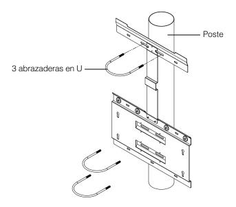
Figura 2-19 Vista delantera de la instalación del montaje en postes
