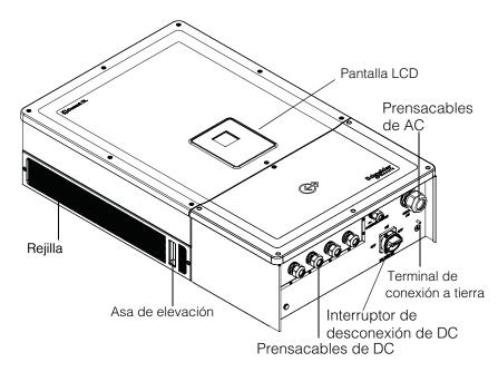
**Figura 1-4** Ubicación de las características físicas del inversor y de la caja eléctrica; vista lateral izquierda
