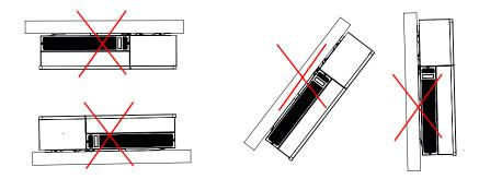
Figura 2-7 Posiciones de montaje inadecuadas
