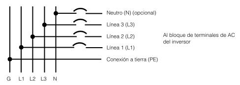
Figura 2-38 Detalles de la conexión de AC
