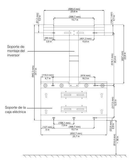
Figura 2-15 Dimensiones de los soportes de montaje: caja eléctrica e inversor
