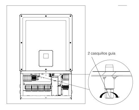
Figura 2-30 Asegurar el inversor a la caja eléctrica
