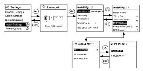
Figura 2-35 Configuración del MPPT mediante el menú Install Settings
