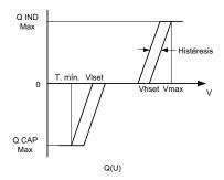
Figura 3-18 Potencia reactiva como función del voltaje
