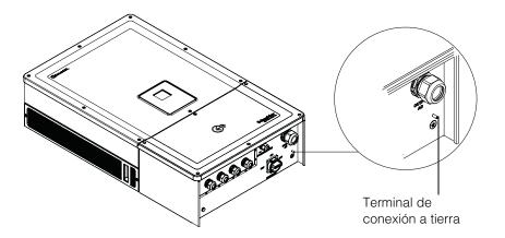
Figura 2-40 Conexión del conductor de la toma de tierra
