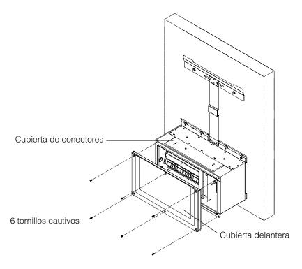
Figura 2-25 Apertura de la cubierta delantera de la caja eléctrica
