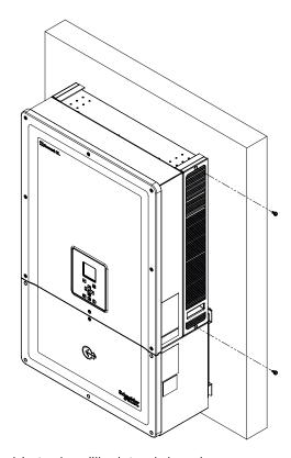
Figura 5-1 Aflojar la cubierta de rejilla; lateral derecho
