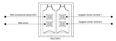
**Figura 2-48** Detalles de los terminales de contacto de relé y RPO (apagado remoto)
