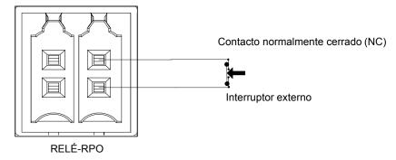
Figura 2-51 Conexión de RPO para un solo inversor
