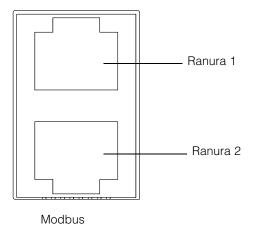
Figura 2-44 Conectores Modbus (RS485)
