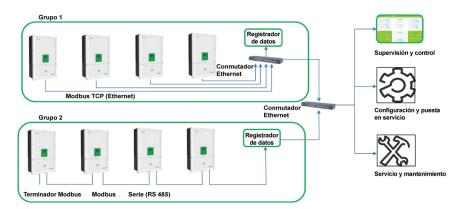
Figura 2-47 Conexiones del Grupo 1: Modbus TCP y Grupo 2: Modbus RS485
