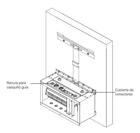
Figura 2-27 Fijación de la cubierta de conectores
