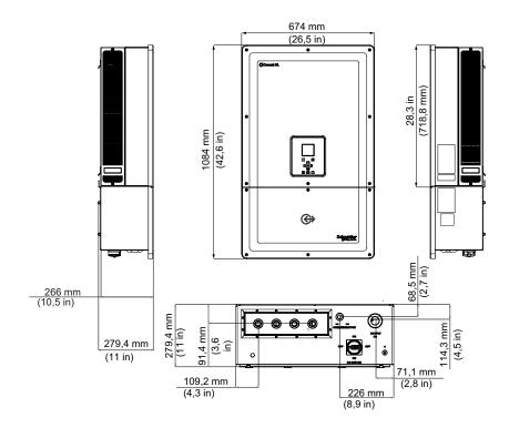
**Figura 2-9** Vistas y dimensiones del inversor y la caja eléctrica (Essential/Optimum)
