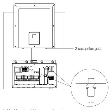
Figura 2-29 Montaje del inversor: vista delantera
