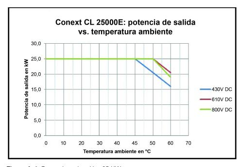
Figura A-4 Curva de reducción: 25 KW
