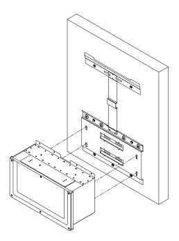
Figura 2-23 Montaje de la caja eléctrica en el soporte
