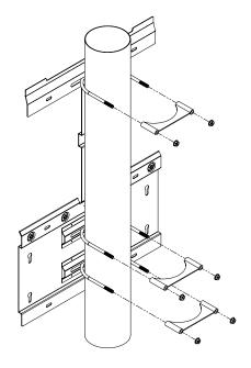
Figura 2-20 Vista trasera de la instalación del montaje en postes
