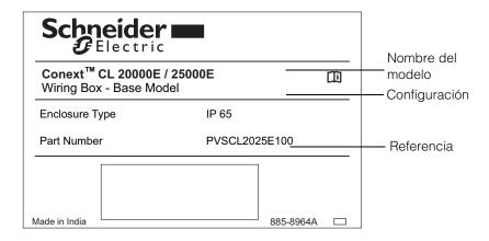
Figura 2-2 Etiqueta de la placa: caja eléctrica
