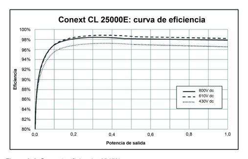
Figura A-2 Curva de eficiencia: 25 KW
