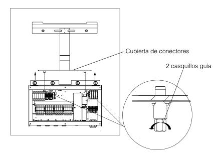
Figura 2-26 Retirar la cubierta de conectores
