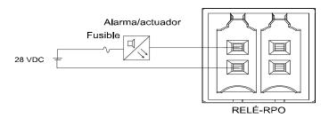
Figura 2-49 Conexión de relés de contacto seco
