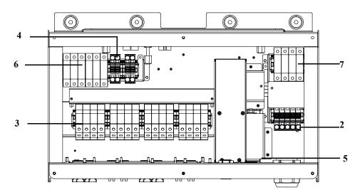
Figura 2-14 Caja eléctrica: Optimum plus (PVSCL2025E301)
