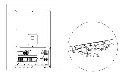
Figura 2-31 Asegurar el inversor y el conector de alimentación de la caja eléctrica
