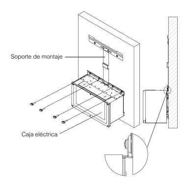
Figura 2-24 Fijación de la caja eléctrica al soporte de montaje
