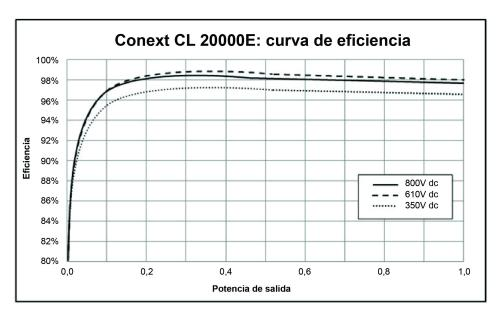
Figura A-1 Curva de eficiencia: 20 KW
