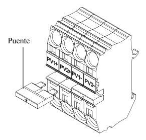
Figura 2-34 Disposición de puentes y conectores de cortocircuito de MPPT
