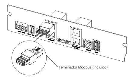
Figura 2-46 Configuración encadenada
