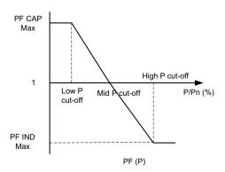
Figura 3-17 Potencia activa como función del factor de potencia
