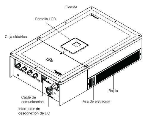
**Figura 1-3** Ubicación de las características físicas del inversor y de la caja eléctrica; vista lateral derecha
