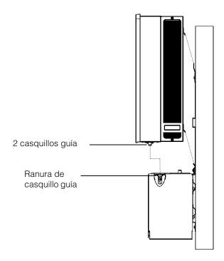
Figura 2-28 Montaje del inversor: vista lateral
