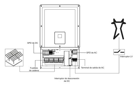
Figura 1-1 Instalación típica (configuración de Optimum plus)
