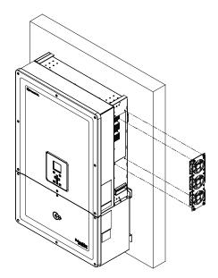
Figura 5-6 Retirar el ventilador
