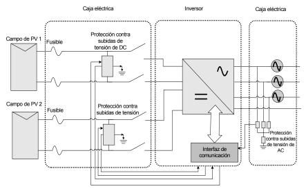
Figura 2-53 Cableado de dispositivo de protección contra subidas de tensión
