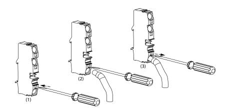
Figura 2-37 Instalación de cables
