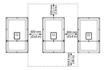
Figura 2-8 Distancias de instalación adecuadas del inversor
