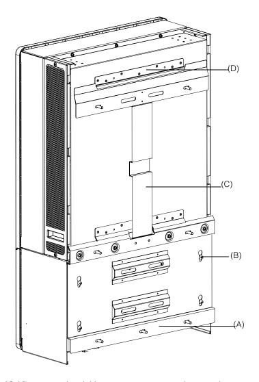
Figura 2-18 Vista posterior del inversor con soporte de montaje
