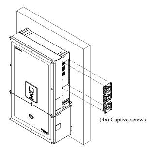
Figure 5-6 Removing the fan
