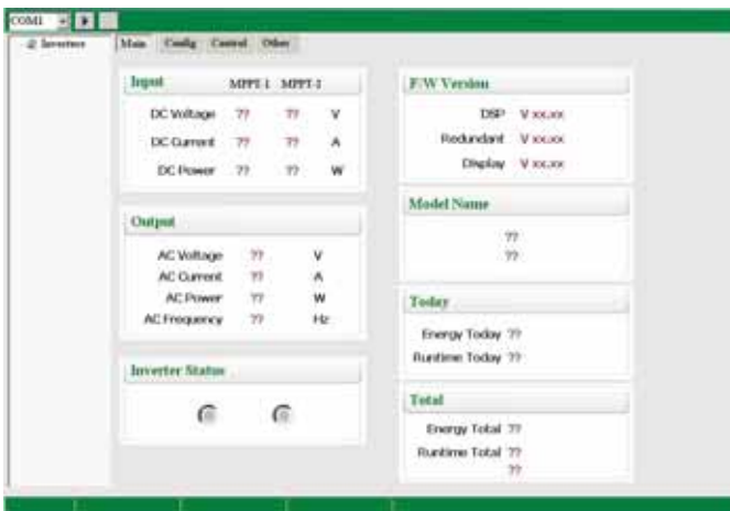
Figura 3-13 Supervisión del inversor
