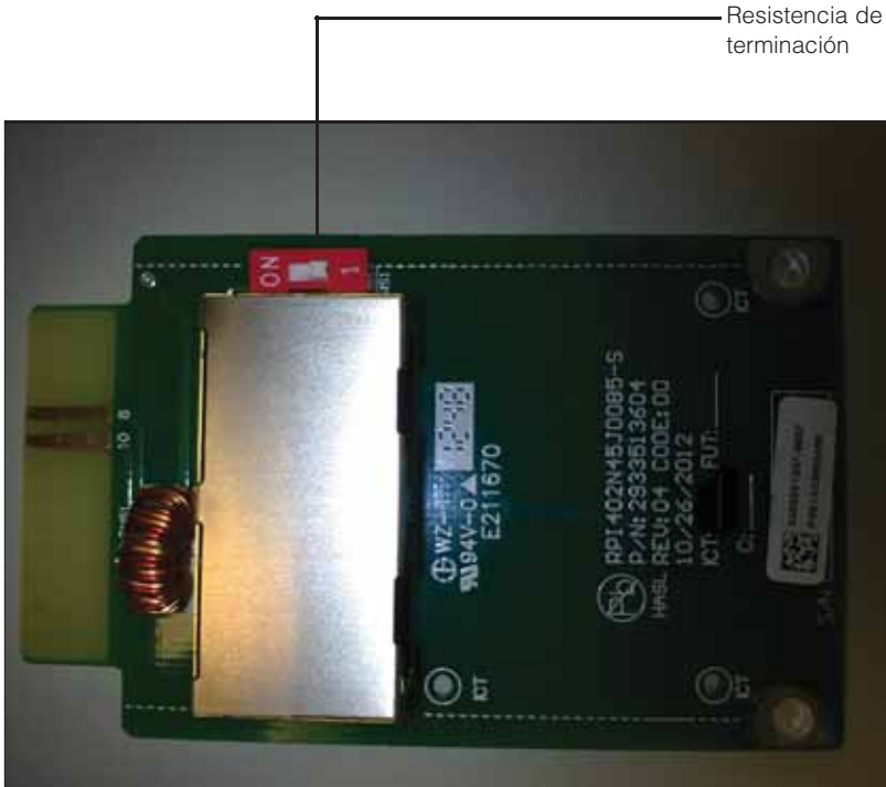
Figura 2-39 Resistencia de terminación, numeración de interruptores
