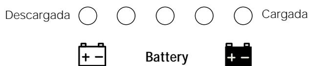
Figura 2-2 Indicadores LED de nivel de batería
