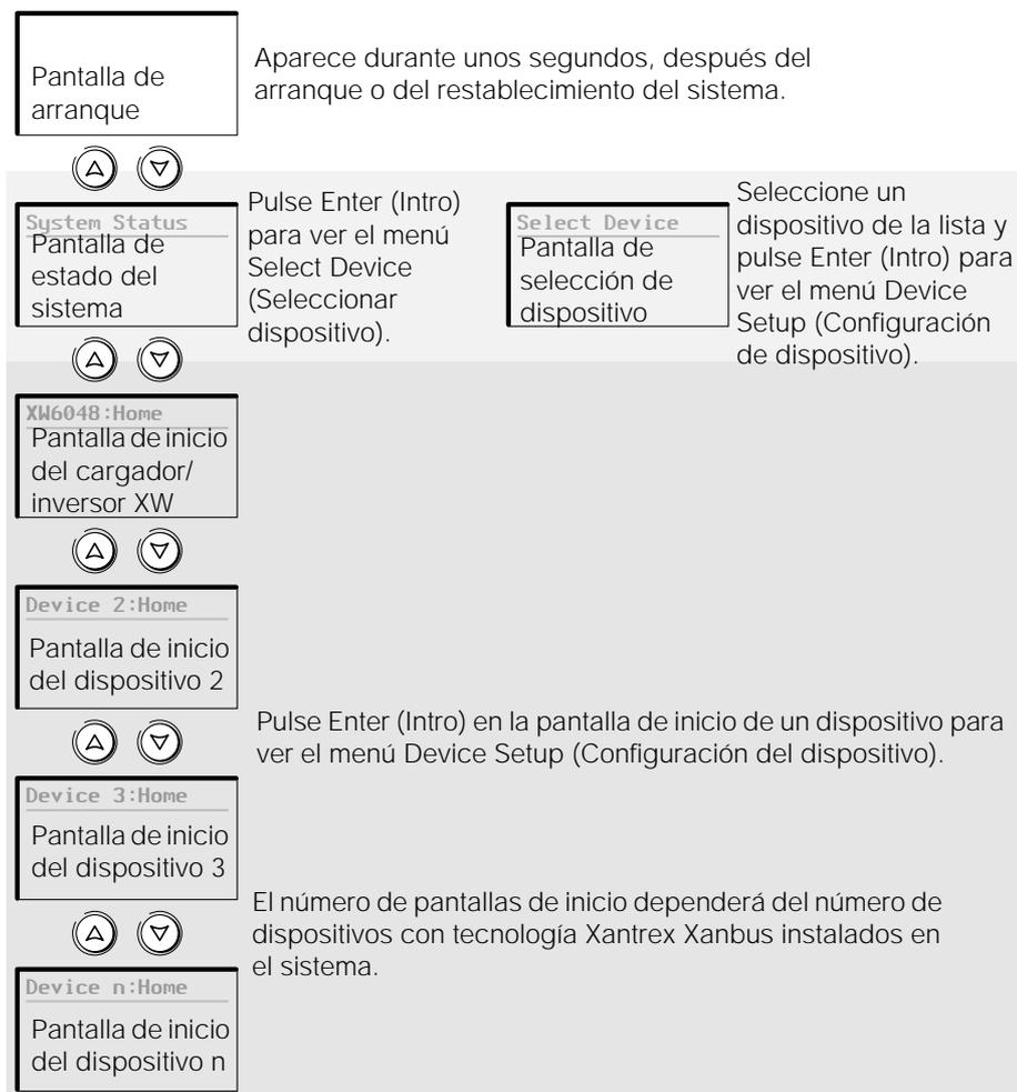
**Figura 2-3** Pantallas del nivel superior del panel de control del sistema Xantrex XW
