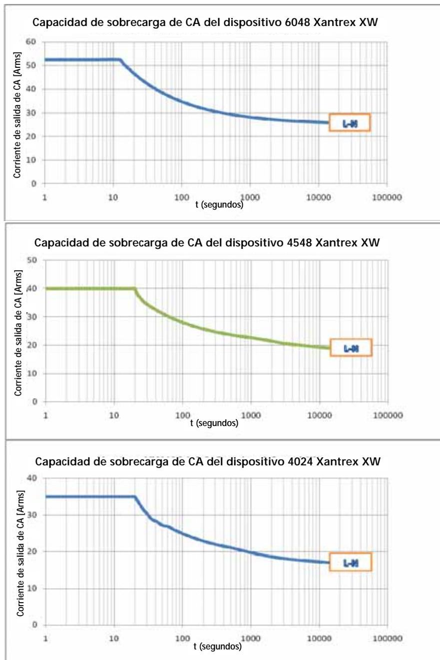
Figura A-1 Capacidad de sobrecarga de CA del cargador/inversor de la serie Xantrex W
