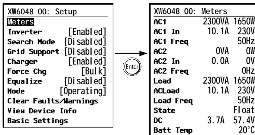
Figura 2-7 Visualización de la pantalla Meters (Contadores)
