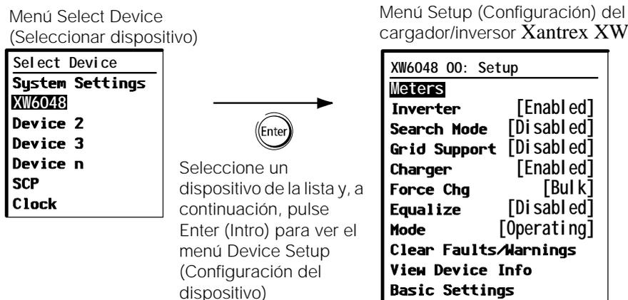
Figura 2-4 Selección de un menú Device Setup (Configuración del dispositivo)
