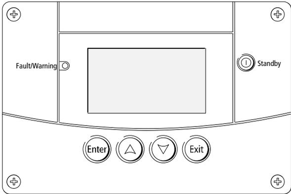
Figura 1-2 Panel de control del sistema Xantrex XW
