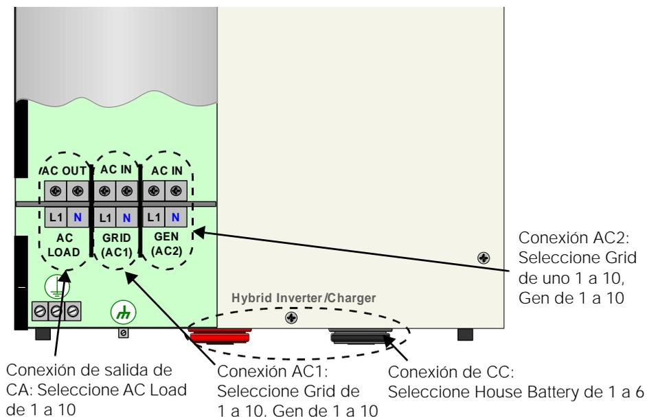
**Figura 3-8** Representación de las conexiones del cargador/inversor de la serie Xantrex XW
