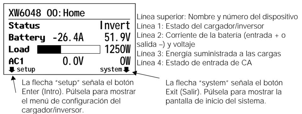
**Figura 2-6** Pantalla Home (Inicio) del cargador/inversor de la serie Xantrex XW
